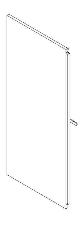
Blechstärke: 2[0,08] / 14 ga Schutzleiteranschluss: Bolzen M8 x 20
