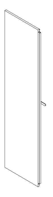
Blechstärke: 2[0,08] / 14 ga Schutzleiteranschluss: Bolzen M8 x 20
